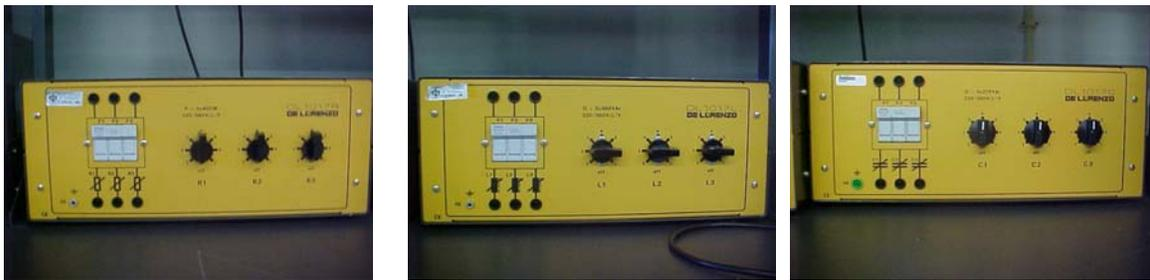
2. Efectue medições de tensão, corrente e potência nas cargas. Comente os valores obtidos.
